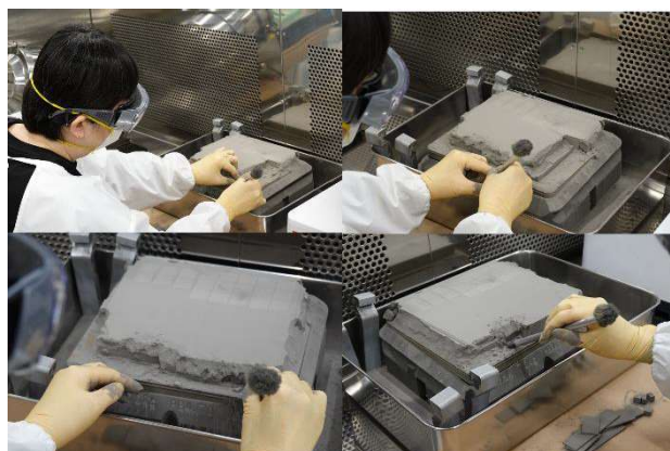
図4：造形工程終了後の造形物取り出し作業の様子
