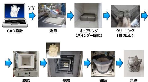
図3：バインダージェット方式の金属3Dプリンタによる製造の流れ
