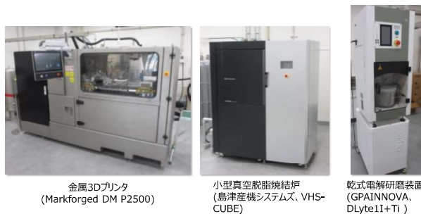
図 1：金属 3D プリンタ本体及び造形に関連する装置
