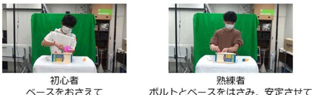
図 10 仮締め動作における左手の動作の差異
