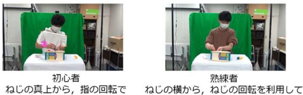
図 9 仮締め動作における右手の動作の差異
